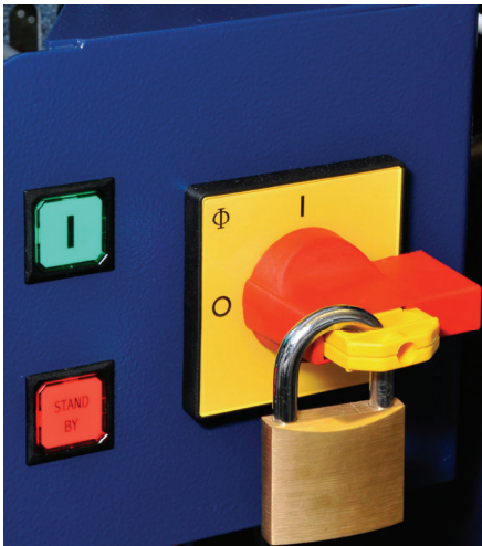
Abb. 9: Das Gerät kann gegen unbefugte Benutzung mit einem Sicherheitsschloss gesichert werden. Einschalten des Gerätes ist im abgeschlossenen Zustand nicht möglich. Alle internen elektrischen Leitungen, die trotzdem Strom führen können, sind orange isoliert.
