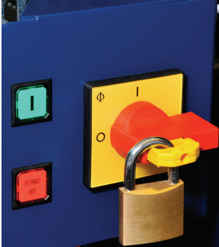
Abb. 14: Das Gerät kann gegen unbefugte Benutzung mit einem Sicherheitsschloss gesichert werden. Das Einschalten des Gerätes ist im abgeschlossenen Zustand nicht möglich. Alle internen elektrischen Leitungen, die trotzdem Strom führen können, sind orange isoliert. Röntgenstrahlung kann im abgeschlossenen Zustand nicht erzeugt werden.
