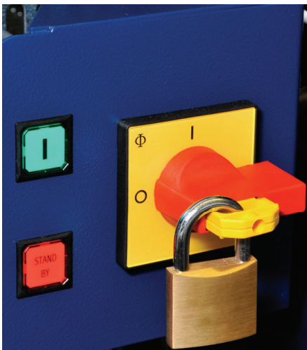
Fig. 14: Le système peut être protégé contre l'utilisation non autorisée à l'aide d'un cadenas. Il n'est pas possible de mettre l'appareil en marche quand il est verrouillé. Toutes les lignes électriques internes qui peuvent néanmoins être sous tension, sont isolées en orange. La génération de rayons X est impossible si le système est verrouillé.
