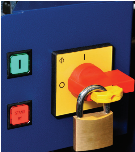
Fig. 9: El sistema se puede proteger contra el uso no autorizado a través de una cerradura de seguridad. No es posible conectar el sistema si está cerrado. Todas las líneas eléctricas internas que podrían estar bajo tensión están aisladas con cinta de color naranja.
