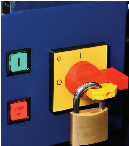
Fig. 14: El equipo se puede proteger contra el uso no autorizado a través de una serradura de seguridad. No es posible encender el equipo cuando está cerrado. Todas las líneas eléctricas internas que pueden estar bajo tensión están aisladas con cinta de color naranja. En el estado cerrado no se pueden generar rayos X.
