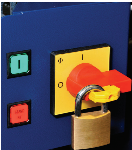
Fig. 9: Le système peut être protégé contre l'utilisation non autorisée à l'aide d'un cadenas. Il n'est pas possible de mettre l'appareil en marche quand il est verrouillé. Toutes les lignes électriques internes qui peuvent néanmoins être sous tension, sont isolées en orange. La génération de rayons X est impossible si le système est verrouillé.
